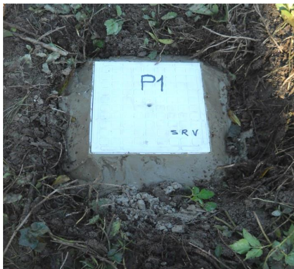
Pozzetto piezometro P1
