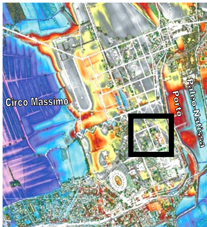
Modello digitale del terreno a conturaggio colorimetrico sulla scala delle altezze. Con i colori chiari sono evidenziate le aree a quota più elevata. E' evidenziato il sito in esame ed il paleo-alveo del T.Natissa (Rilievo estratto da Coren, Visintini, Fales, Sterzai, Prearo, Rubinich, 2005).
