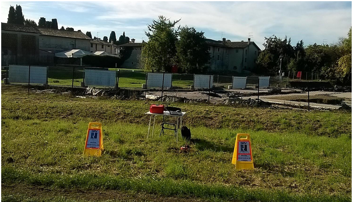
Esecuzione indagine sismica MASW e HVSR
