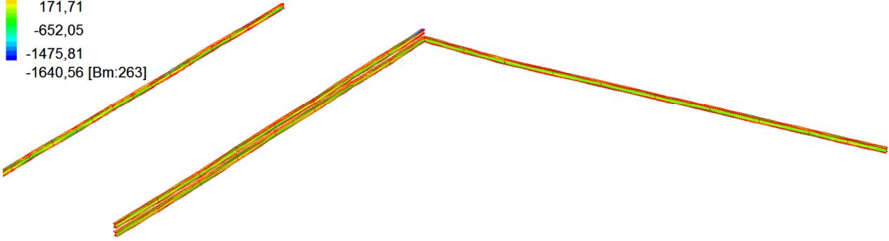
**Stress statica SLU – massima su profilo UPN200 e UPN220 (solo diagonali a trazione delle reticolari di copertura)**
